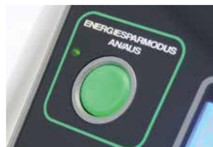
Wird der Energiesparmodus zugeschaltet, verdunkelt sich das Display und der Stromverbrauch sinkt um 4 Watt.
