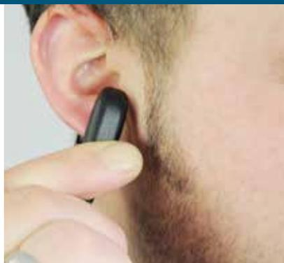
Das KETTLER TOUR 9 bietet die Möglichkeit, die Herzfrequenz auch mithilfe eines Ohrclips zu ermitteln.
