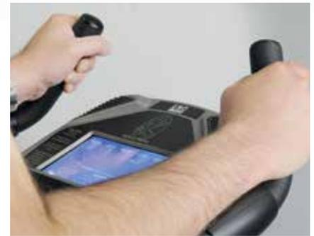
die maximale Herzfrequenz demnach 190 ( $220 - 30 = 190$ ). Um möglichst genaue Werte zu erreichen, sollte die Messung der Herzfrequenz telemetrisch über einen Brustgurt erfolgen. Handpulsensoren liefern teilweise – je nach nachdem, ob die Hände des Sportlers zur Zeit der Messung ggf. in besonderem Maße mit Hornhaut versehen, zu nass sind o. ä., falsche Ergebnisse.
