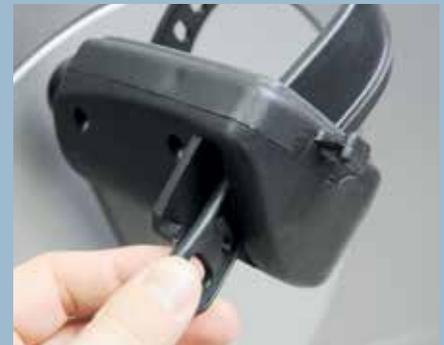
► Um während des Trainings ein Abrutschen der Füße von den Pedalen zu verhindern, sollten die Fußriemen der Größe der beschuhten Füße angepasst werden.
